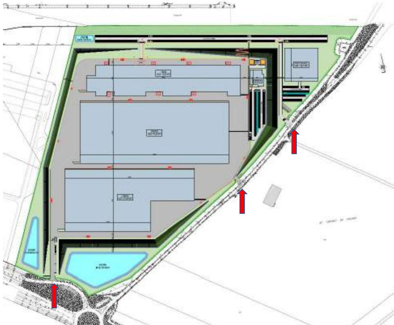
Projet industriel à terme : accès via RD 167 et par la contre-allée depuis le giratoire
